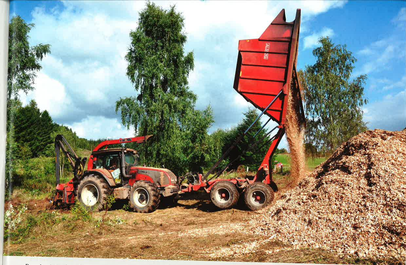
Bevoksningsgående flishuggere anvendes i stort omfang. I mange tilfælde anvendes desuden bæltter på køretøjet for at skåne jordbunden.
